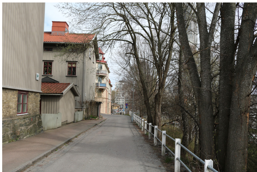
Arbetarbebyggelsen på Skateberget till vänster i bild. Till höger ett räcke som avgränsar mot den gröna slänten. Räckets stolpar består av kapad järnvägsräls.
